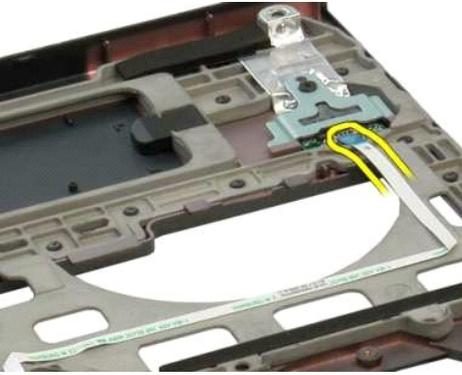
13. Rimuovere la vite che fissa la staffa del lettore di impronte digitali al telaio del computer.
