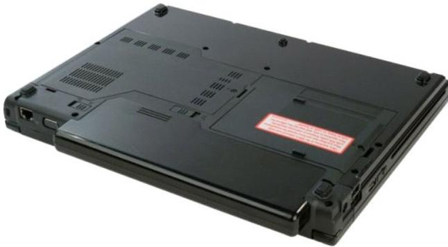
2. Far scorrere il dispositivo di blocco della batteria sulla sinistra per allontanarlo dalla batteria.
