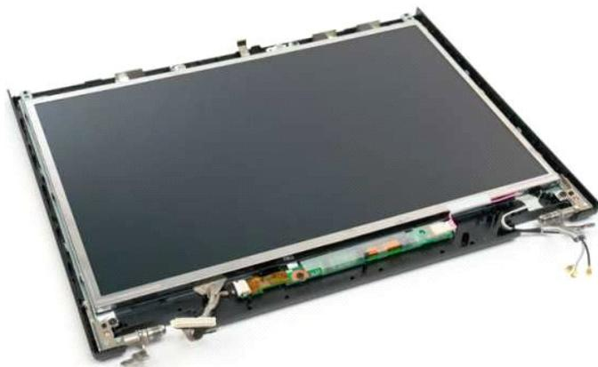
4. Rimuovere le due viti che fissano il pannello dello schermo LCD al gruppo dello schermo.
