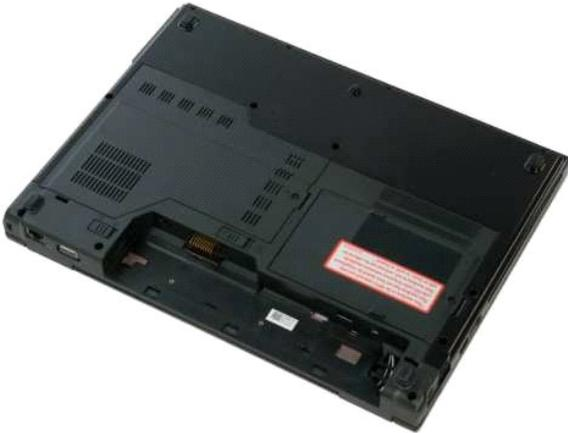
3. Rimuovere la vite che fissa il pannello di accesso del disco rigido alla base del computer.
