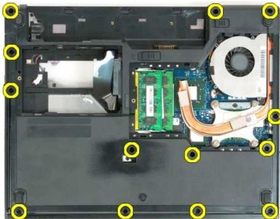
10. Capovolgere il computer e sganciare il fermaglio del cavo dati del lettore di impronte digitali.
