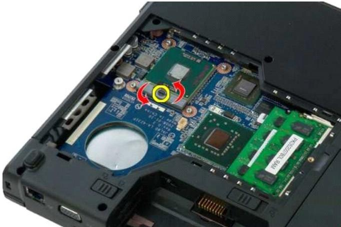
9. Sollevare il processore dallo zoccolo tenendolo in verticale, facendo attenzione a non piegare i piedini del processore.
