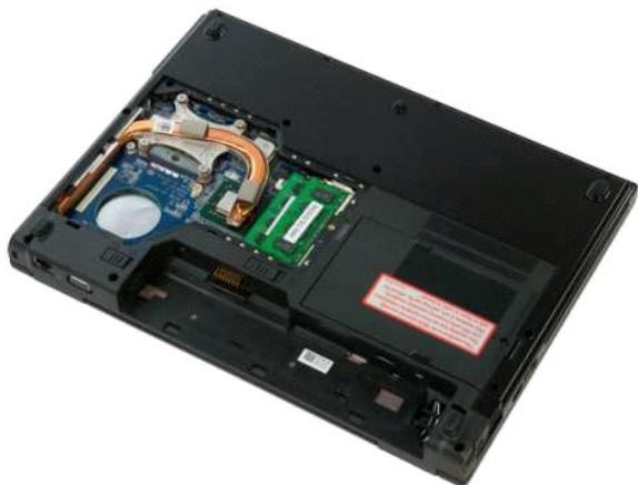
4. Per ogni modulo di memoria presente nel computer, allargare delicatamente con i polpastrelli i fermagli di fissaggio su ciascuna estremità del connettore del modulo di memoria fino a liberare il modulo di memoria.
