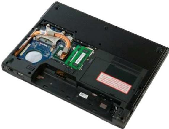
5. Allentare le quattro viti che fissano il dissipatore di calore al telaio.
