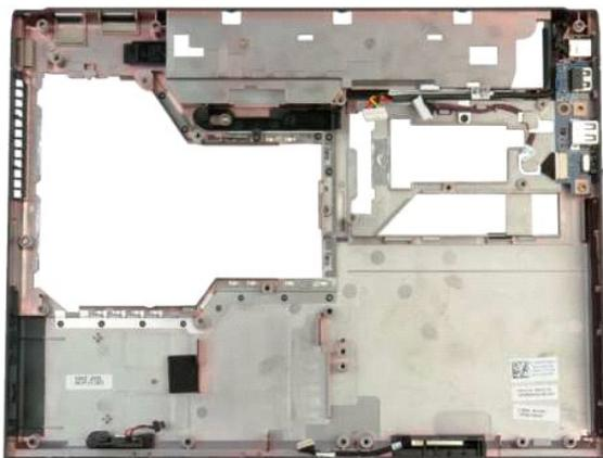
14. Rimuovere le due viti che fissano il gruppo degli altoparlanti al telaio.
