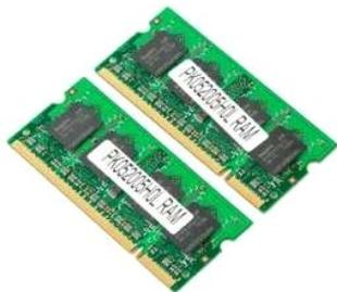
**☑ N.B.:** il DIMM A è il modulo più vicino alla scheda di sistema. Non è possibile rimuovere il modulo DIMM A se non si rimuove prima il modulo DIMM B. Se è presente un solo modulo DIMM, deve essere sempre installato nello slot DIMM A. Se è presente un solo modulo DIMM, quando si sposta la memoria dal modulo DIMM A al modulo DIMM B viene disabilitato AMT (se abilitato).
